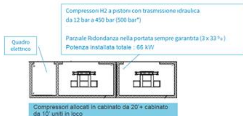
Figura 50. Configurazione tipica del container "compressione"(immagine esemplificativa)
